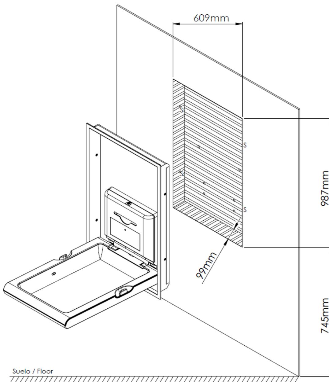
Cuando se instale el kit de empotrado se debe tener en cuenta que la parte inferior del cambiador de pañales debe quedar a una altura aproximada de 800 mm respecto al suelo
